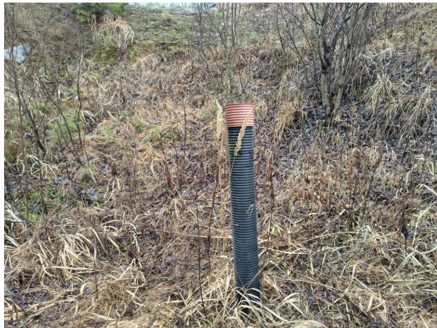
Kuva 3. Putki, josta mitattiin maastomittausten ohessa pohjaveden taso
